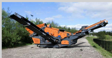
Die neue Grobstücksiebmaschine MR6 von Portafill und könnte wahlweise vor oder nach dem Metrotrak eingesetzt werden.
