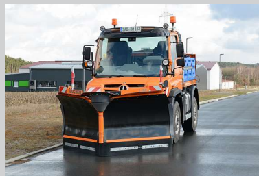
Keil-Vario-Schneepflug Bucher ULN 30 mit Pflugschar aus hochresistentem Spezialkunststoff und optionalem Doppelschürfleistensystem.
