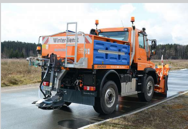
Streuautomat Bucher Yeti 2000 ECO FS 50 mit innenliegendem ECO-Zusatztank. Der Streuautomat fasst 2,0 m 3 Trockensalz und 2.000 Liter Sole.
