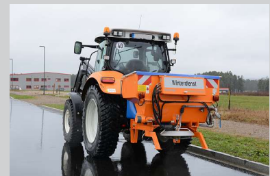
Streuautomat Tracon 800 Plus für den Anbau an Traktoren. Das Behältervolumen liegt bei 0,8 m 3 Trockensalz und 430 Litern Sole.
