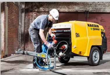
Bewährte Kaeser-Qualität nun auch mit Elektroantrieb. Die neuen mobilen Baukompressoren können auch unter strengsten Auflagen betrieben werden
