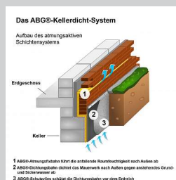
Das ABG-Kellerdicht-System im schematischen Aufbau
