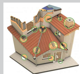
Das diffusionsfähige PAVAFLASH ist ideal für die hinterlaufsichere Abdichtung von Details und Anschlüssen im Holzbau geeignet.
