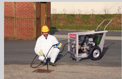
Der benzin- oder dieseltreibene Reiniger ist im Gelände ohne Infrastruktur im Einsatz.
