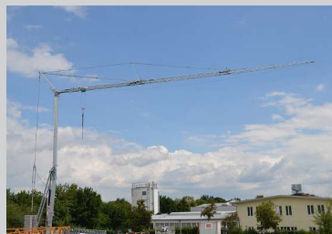
BKL System Cattaneo Schnellmontagekran CM 90S4 mit 41 m Ausladung und 4 t max. Traglast
