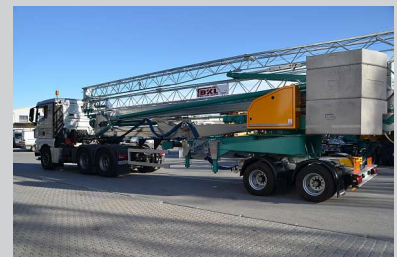
BKL System Cattaneo mobiler Schnellmontagekran CM 271 mit 27 m Ausladung und 2,5 t max. Traglast beim Transport
