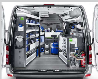
Die modulare bott vario Fahrzeugeinrichtung für Kastenwagen.
