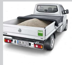
Das Ladungssicherungsgewebe von bott sichert loses Ladegut auf der Pritsche.
