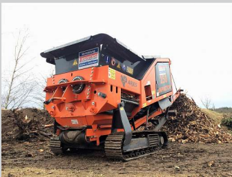
Wir stellen aus: Arjes Impaktor 250 Zweiwellenbrecher für Bauschutt, Beton, Asphalt, verschiedene Natursteine
