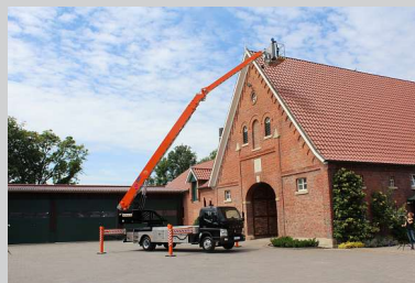
Der Autokran lässt sich schnell und ohne Werkzeug in eine Arbeitsbühne verwandeln.
