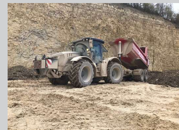
Der robuste Halfpipe-Kipper aus Hardox-Stahl für den Transport von Sand, Kies und Bauschutt
