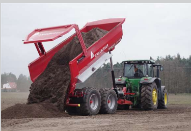
Die Halfpipe-Mulde hat eine Nutzvolumen von 12.5 m 3 und besteht aus HARDOX-Stahl
