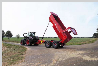
Standsicher mit hohem Kippwinkel von 54° - äußerst robuster Rahmen mit ungefedertem Profi-Pendelfahrwerk
