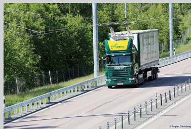
Pilotprojekt „E-Highway“ auf der BAB A 1 zwischen Reinfeld und Lübeck
