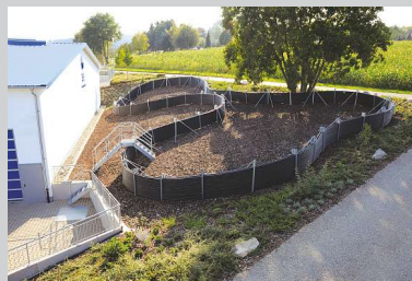
Einblastestrecke für Glasfaserkabel und Subducts, Länge max. 4000 m
