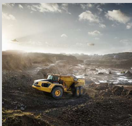
Der neue A60H mit einer Kapazität von 60 Tonnen ist der größte knickgelenkte Dumper, den Volvo Construction Equipment aktuell zu bieten hat.
