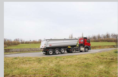
Messepremiere: konische Stahl-Halbschale aus der neuen SMART-line Baureihe
