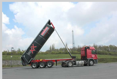
Sattelkipper mit Stahl-Halbschale in isolierter ISOXX-Version für den Transport von Asphalt. Die Isolierung entspricht der DIN 70001
