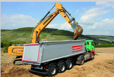
Sattelkipper mit Aluminium-Kastenmulde und Okulen-Auskleidung
