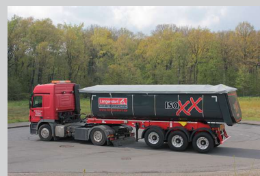
Stahl-Halbschalenkipper ohne Schütte in der isolierten ISOXX-Ausführung
