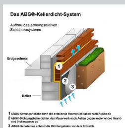
Das ABG-Kellerdicht-System im schematischen Aufbau
