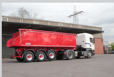
Leichte Aluminium-Kastenmulde mit Schütte in der isolierten ISOXX-Ausführung
